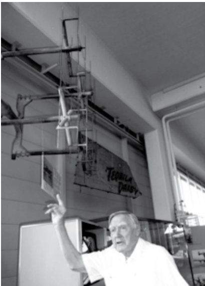
Peter Spoden erklärt die Lichtenstein-Antenne seines St Kdt Johnen. Peter Spoden explique l'antenne Lichtenstein de son Cdt Esc Johnen.
